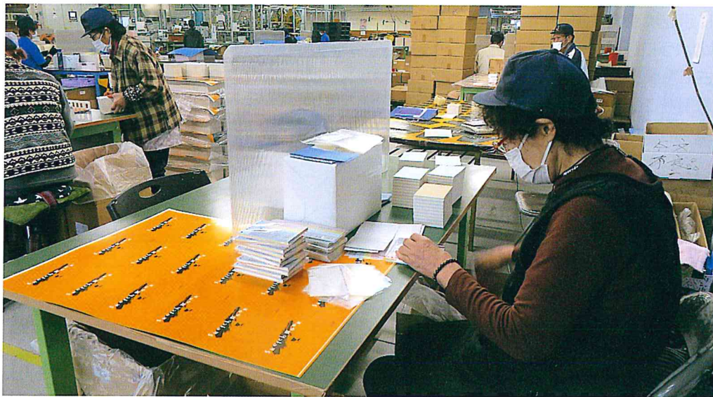
飛沫感染予防のため作業台に半透明のアクリル板のボードが立てられているが(点線部分)、最近では接触感染防止、「3密」回避も取り沙汰され、対面作業を排除した徹底的な衛生管理がなされている。
